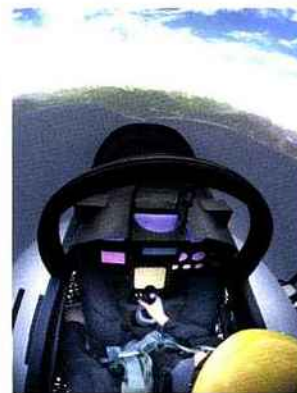
Dans le simulateur Avions de chasse, les cockpits montés sur rails, s'imbriquent à l'intérieur des écrans « demi sphère » dès que le pilote (en tenue de vol, svp) est installé aux commandes.
