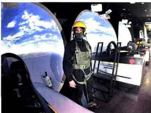
Dans le simulateur Avions de chasse, les cockpits montés sur rails, s'imbriquent à l'intérieur des écrans « demi sphère » dès que le pilote (en tenue de vol, svp) est installé aux commandes.
